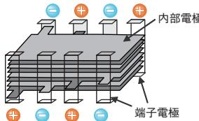
8つの端子電極を+/-交互に接続することで電流の流れを逆向きにし、発生する磁界を相殺する。
