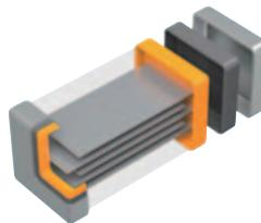
対向する内部電極が交互に積層される一般的な構造。
