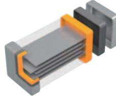
陶瓷电解质和内部电极相互叠层的结构
