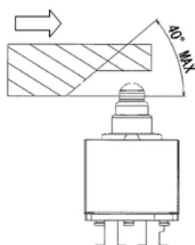
C7. Normal using condition should not keep depress the plunger, please consider designing to select either Normally open or Normally close appropriately. 通常のご使用状態がスライドを押し込んだままにならないよう、ノーマルオープン、ノーマルクローズを選択した機構設計を推奨致します。
