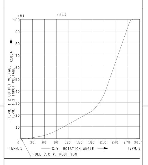
AT 150° C.W. SHAFT ROTATION FROM FULL C.C.W. POSITION VOLTAGE PERCENT SHALL FALL WITHIN THE LIMITS OF 10-25 PERCENT.
