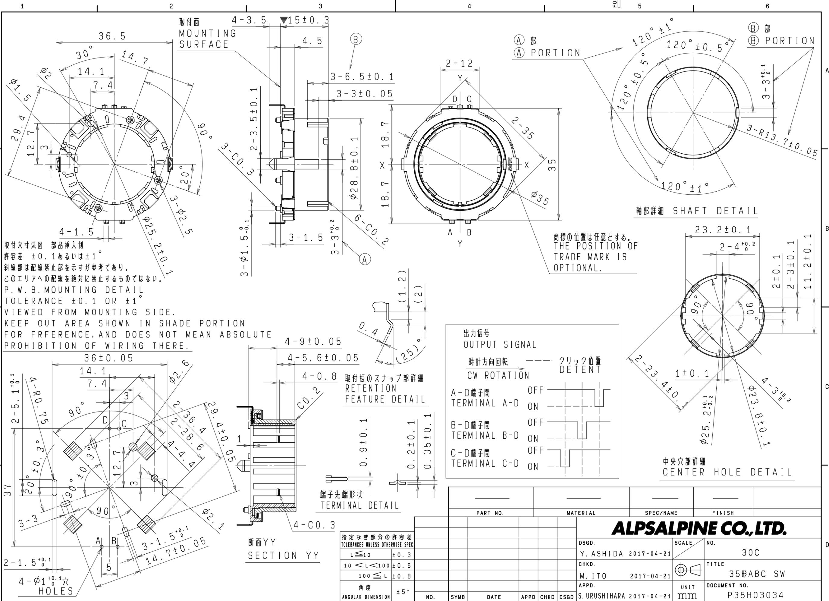
取付穴寸法図 部品挿入側
