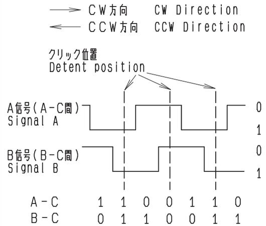
クリック位置より、A信号が先に変化後、B信号が変化した時にCW方向と判定。
