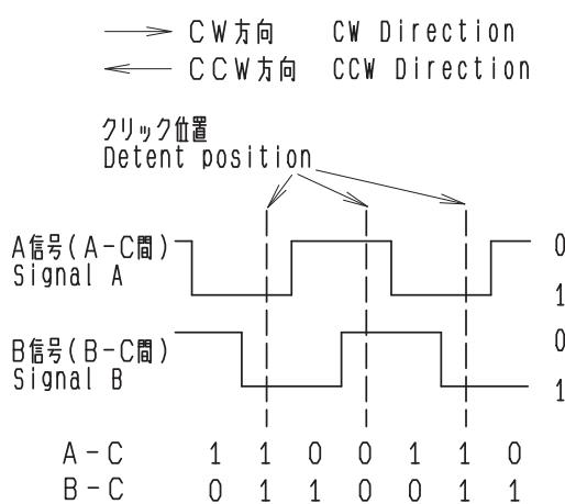
クリック位置より、A信号が先に変化後、B信号が変化した時にCW方向と判定。
